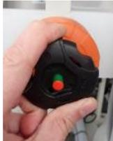
2. Feche a válvula de membrana (2) rodando-a para a direita.
