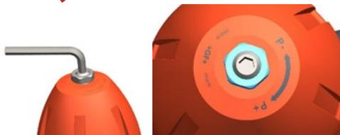
4. Defina a pressão de concentrado para 1 bar  $\pm$  0,2 rodando a válvula de concentrado (válvula de operação de emergência) (26). A pressão pode apresentar 0-4 bar no manómetro.
