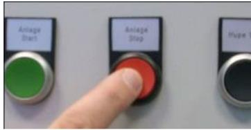
Em qualquer altura, a Limpeza a quente pode ser interrompida premindo o botão vermelho. A unidade arrefece de forma autónoma.
