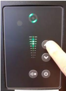
1. Conforme descrito na secção 14 , selecione a operação de emergência "apenas 2º estágio".
