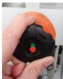
10. Abrir nuevamente la válvula de membrana. Verificar la estanqueidad del filtro
