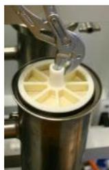
6. Extraer la membrana tirando hacia arriba con una pinza.
