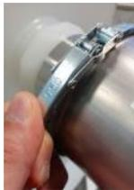
1. Retirar el pasador de seguridad y abrir la abrazadera de retención.
