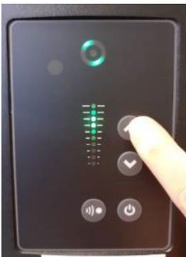
3. Ajuste el valor presionando el botón de flecha en la bomba. (Presión de la bomba 10-15 bar)
